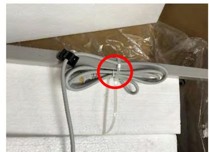
Sobald die Kabel gelöst sind, können die Stecker an die Motoren angeschlossen werden. Dazu müssen Sie zunächst die Sperr-"Clips" entfernen, wie in der Abbildung unten links gezeigt.
