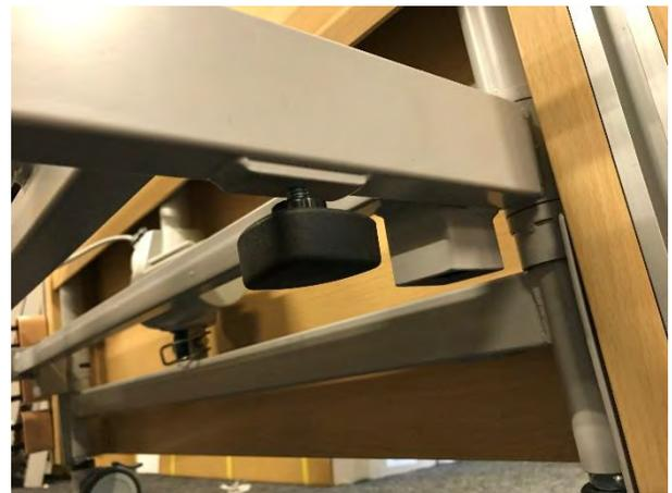
Bitte montieren Sie den Rahmen, wie oben beschrieben und verschrauben Sie Kopf- und Fußteil mit den 4 Rändelschrauben (siehe Fotos oben).
