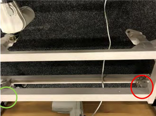
Das Bild links zeigt die Befestigung des Verriegelungsbolzens am Kopfteil in seiner ursprünglichen Position, wie im roten Kreis dargestellt. Hinweis: In der ursprünglichen Position befindet sie sich auf der dem Motor gegenüberliegenden Seite des Rahmens.
